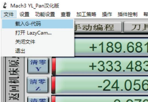
程序加载完成后，点击"循环开始"按钮，运行加工程序；点击"进给保持"按钮，暂停加工程序；点击"停止"按钮，程序停止；点击"复位"按钮，机器紧急停止。
