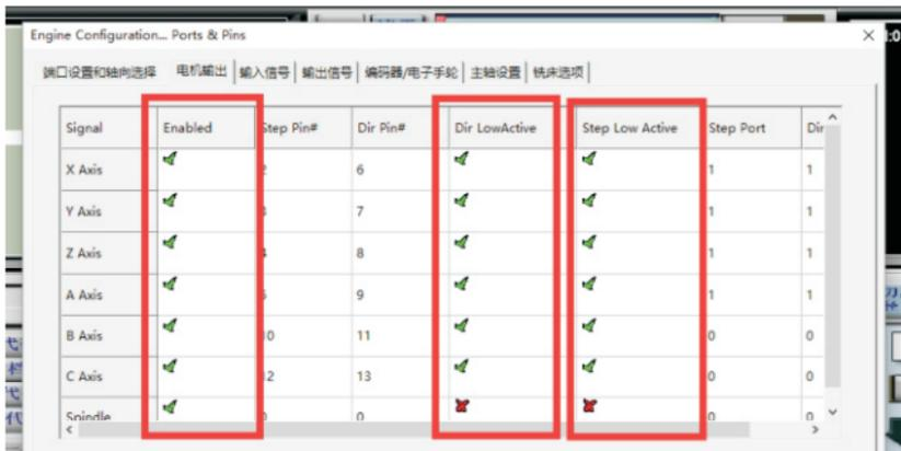
1. **Enable:**打勾将对应的轴输出使能，让其输出有效
